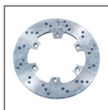
MDFPA1 DISCO AUTOVENTILATO POSTERIORE DIAM. 200mm Disco freno autoventilato posteriore. Diametro Esterno: 200mm Diametro sede portadisco: 100mm Diametro pista frenante interno: 135mm Interasse fori per M6: 114mm Spessore disco: 12mm Mat: Ghisa lamellare (UNI EN 1561 GJL)
